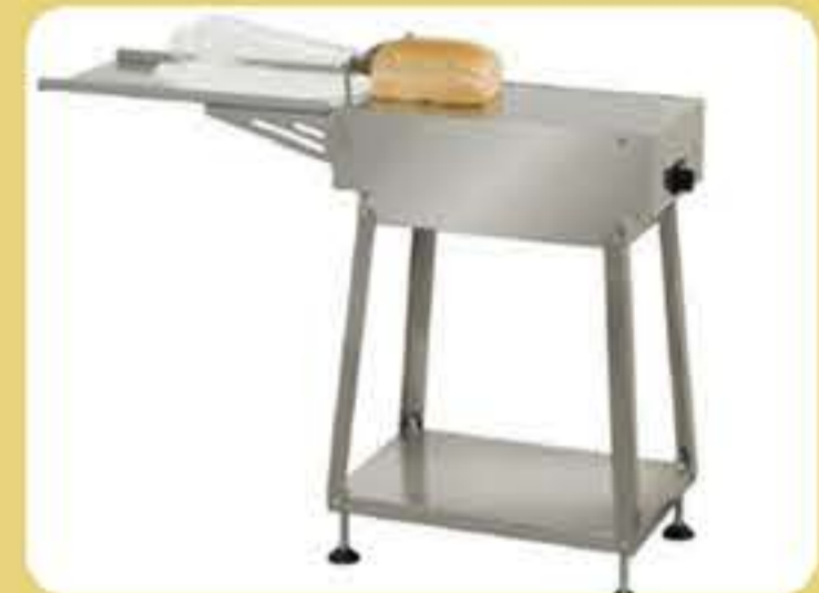
Φυσητήρας αέρα για σακούλες Διαστάσεις: 120 x 30 x 90 cm Ισχύς: 100 Watts - 230V/50Hz/1ph
